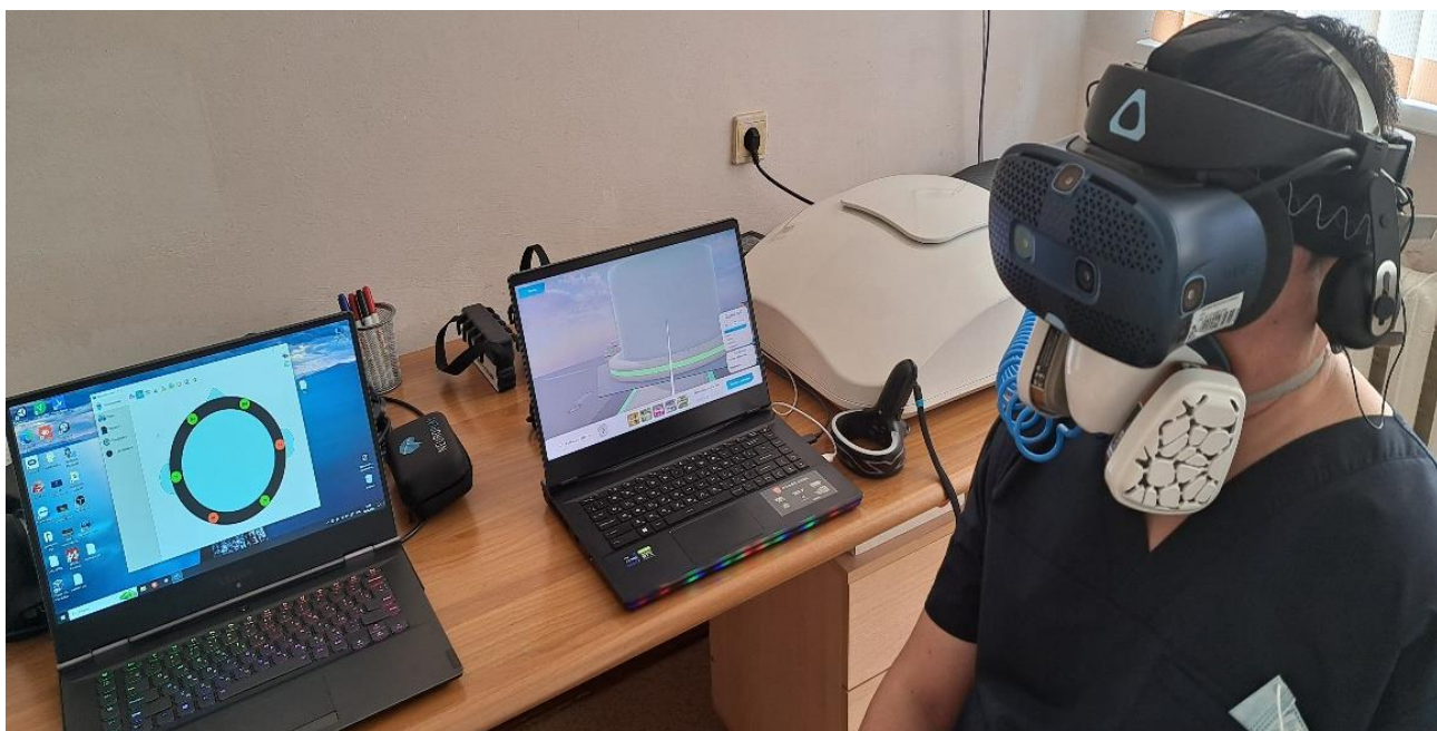
Рисунок 4 — Устройство для диагностики и реабилитации обонятельных нарушений с возможностью компьютерного управления и интеграции с системой биологической обратной связи
