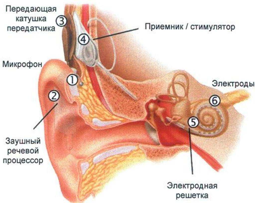
**Рисунок 4 - Расположение различных составляющих системы кохlearной имплантации.**
