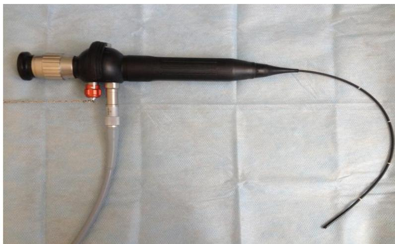
Рис.3 . Гибкий волоконно-оптический рино-ларинго-фиброскоп фирмы KARL STORZ.
