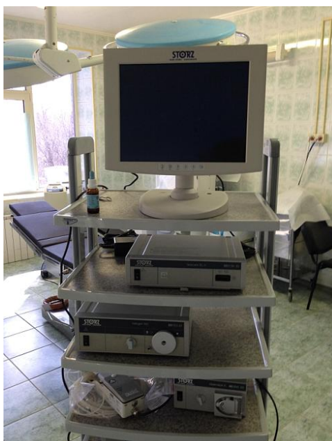
Рис. 4. Эндовидеокамера, сопряженная с персональным компьютером.
