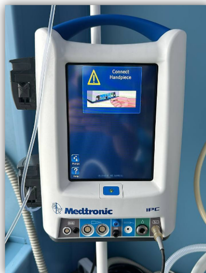
Рисунок 19 – Консоль Medtronic IPC с универсальной рукояткой
