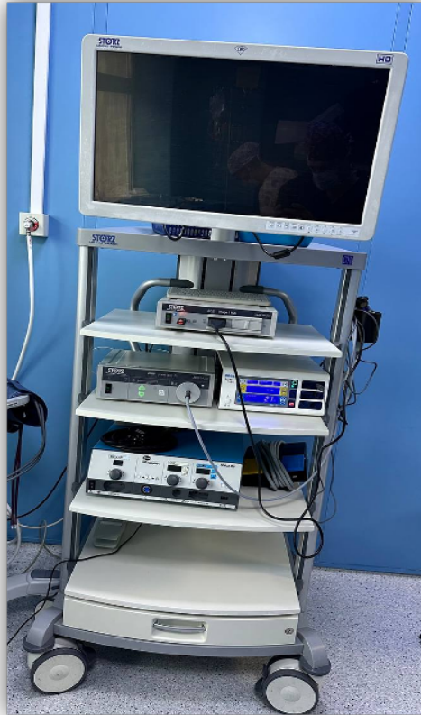
Рисунок 18 – Эндоскопическая видеостойка, система видео и фотофиксации, коагуляционный блок для монополярной и биполярной коагуляции
